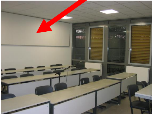
Wandabsorber aus Mineral- faser mit Textilloberfläche
